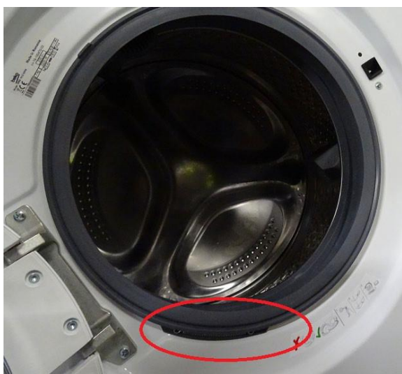
Image 1.18 Démontage / montage de la paroi avant
