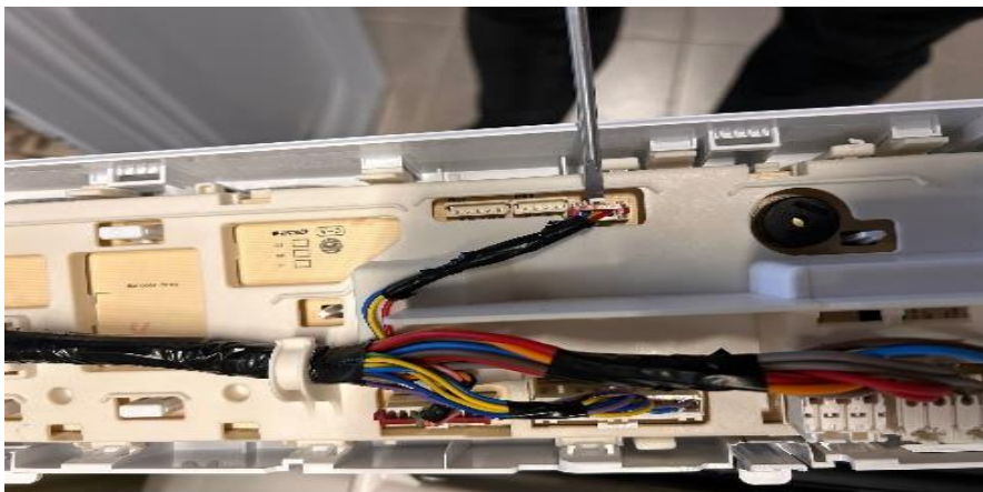
Image 1.11 Demontage/remontage du panneau
