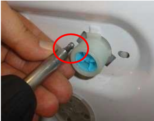
Image 1.43 Installation / Démontage de la vanne
